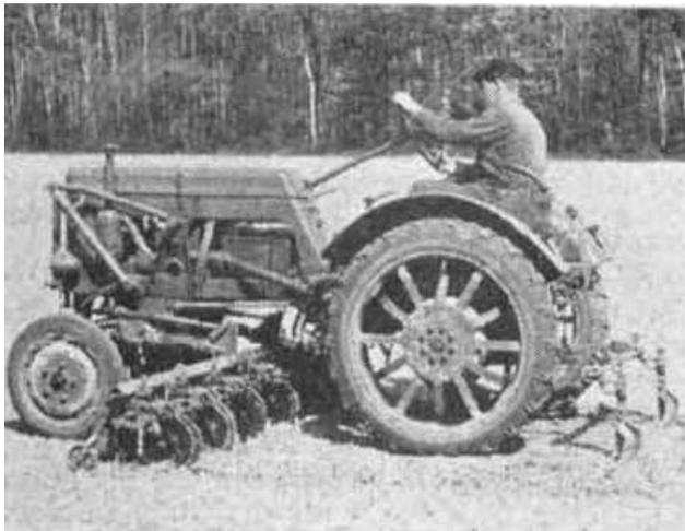
Kleinschlepper mit zwischen Vorder- und Hinterachse angebautem Hackgerät
